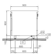
Electrical inlet (power) EQ **Equipotential screw**
